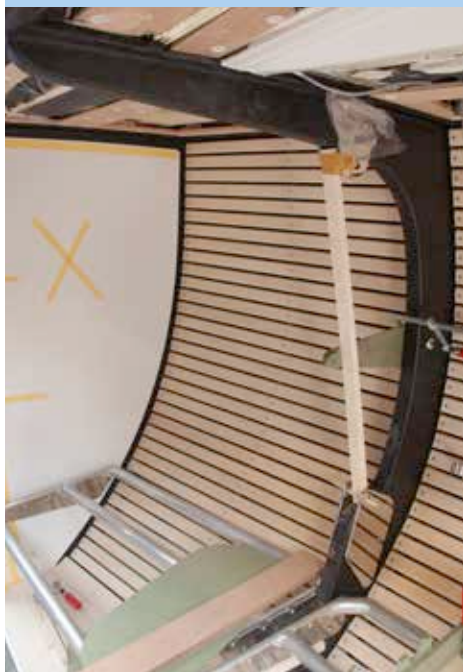
Een carbon kniestuk vangt de krachten van de puttings op.
